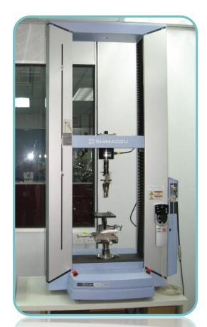
**SHIMADZU Tensile Tester**
